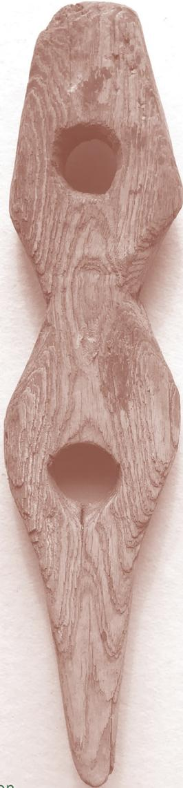
**Die Tacoule:** Eine Art «Heuschlüssel», der zum Festziehen der Hanfseile verwendet wurde, mit denen die «Barillons» (grossmaschige Netze) gebunden wurden. Damit transportierten die Alpenbäuer:innen das gemähte Heu.
